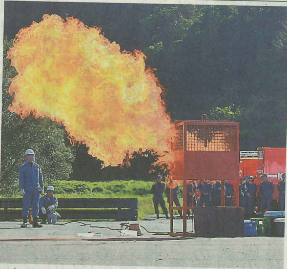
実験で火炎を上げて爆発するスプレー缶 ＝掛川市の小笠山総合運動公園駐車場
